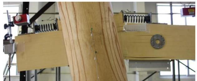
図5 門型試験体貫端部の変形 (1/5rad 時)
