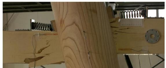
写真1 0.12rad 載荷時の貫の破壊形状(T10B12-261)
